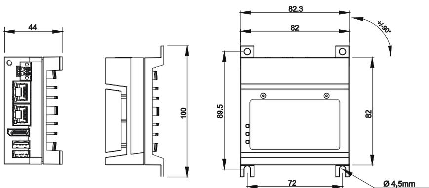
Abb. 13: Montageplatte Seitenwand
