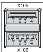
Abb. 4: USB-Schnittstelle Pin-Nummerierung
