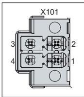
Abb. 2: Spannungsbuchse Pin-Nummerierung
