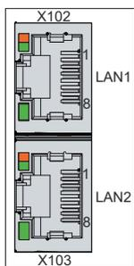
Abb. 3: Ethernet-Schnittstelle Pin-Nummerierung
