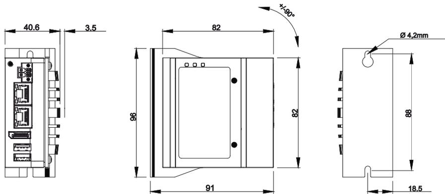
Abb. 12: Montageplatte Rückwand
