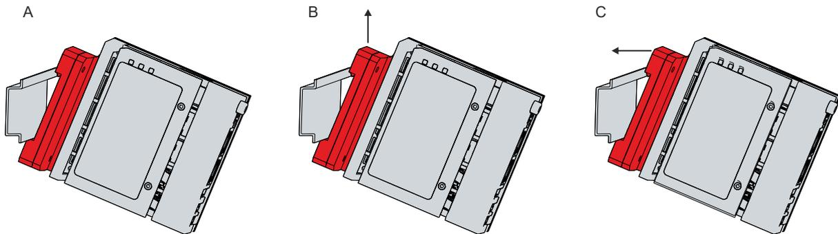
Abb. 16: Schaltschrankeinbau Hutschienenadapter
