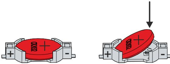
Abb. 26: Batteriewechsel
