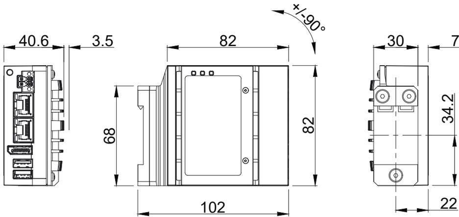
Abb. 14: Montageplatte Hutschienenadapter
